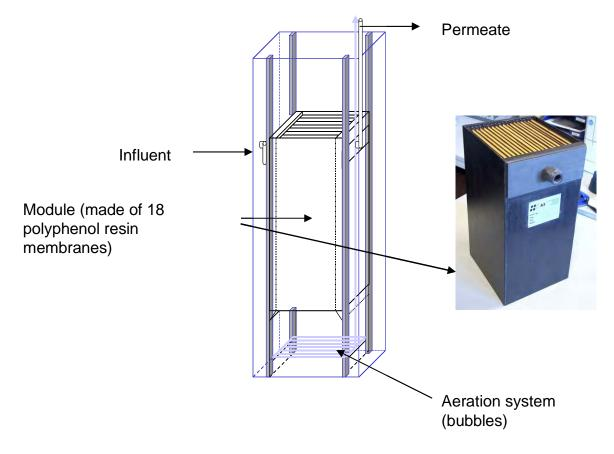
Fig. 2.4.7: Membrane bio-reactor module
